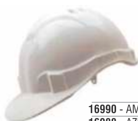
CASCO GENESIS LIBUS CA 36099 Capacete de segurança para uso na indústria, classe B, tipo II, casco composto por 1 nervura, casco de polietileno, suspensão de polietileno, polipropileno e poliamida, tira absorvente de suor de poliuretano e couro sintético. Carneira e coroas em polietileno, polipropileno e poliamida ou em material plástico, tipo separáveis, carneira fixada ao casco através de 08 (oito) pontos de fixação.
