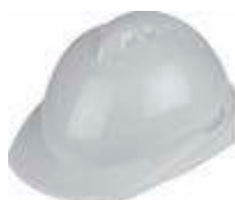
CASCO GENESIS LIBUS CA 36099 Capacete de segurança para uso na indústria, classe B, tipo II, casco composto por 1 nervura, casco de polietileno, suspensão de polietileno, polipropileno e poliamida, tira absorvente de suor de poliuretano e couro sintético. Carneira e coroas em polietileno, polipropileno e poliamida ou em material plástico, tipo separáveis, carneira fixada ao casco através de 08 (oito) pontos de fixação.
